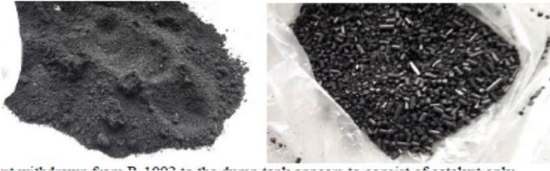
Фотографии катализатора, выгруженного из первого реактора с эбуллированным слоем (левая фотография) и из второго реактора с эбуллированным слоем (правая фотография)
